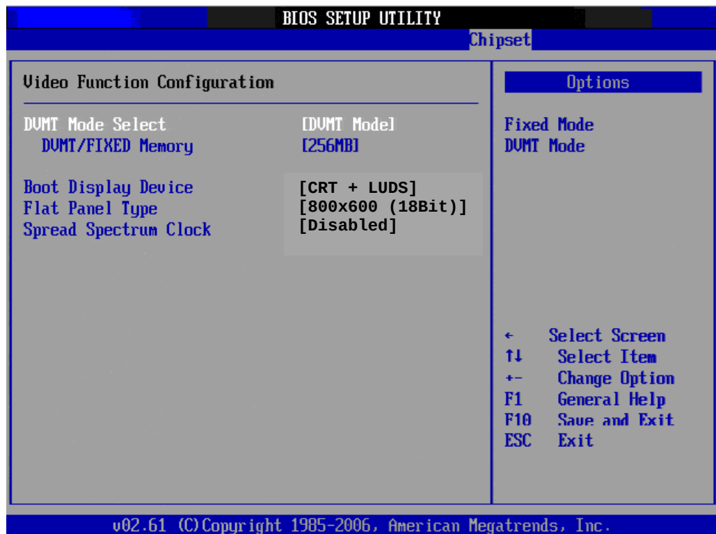
Рисунок Б.20.2 – Подменю настройки видеофункций северного моста
